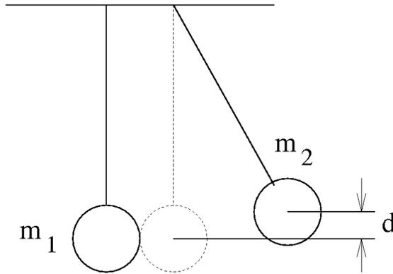
Adote  $m_1=1$  kg,  $m_2=2$  kg,  $d=0,1$  m e  $g=10$  m/s<sup>2</sup>. A esfera 2 é abandonada, vindo a colidir com a esfera 1 na posição indicada como tracejada na figura. A colisão é totalmente inelástica.
