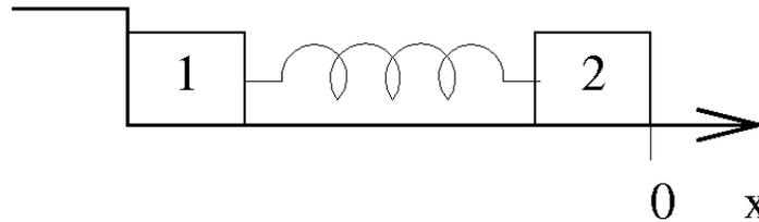
O atrito entre os blocos e a mesa e a massa da mola são desprezíveis. A partir da posição de repouso, a mola é comprimida, deslocando-se o bloco 2 para a esquerda em 0,1 m. Em seguida o bloco é abandonado.
