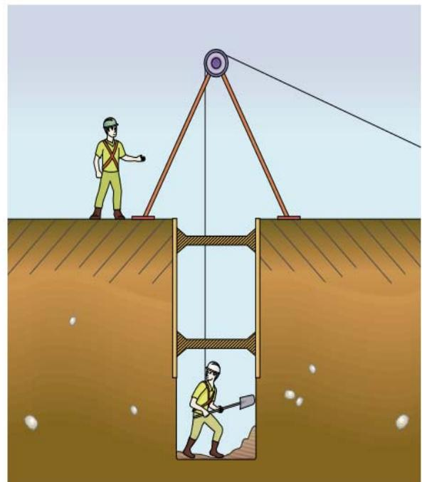
Figura 11 – Atividade realizada na base de escavações profundas e de pequenas dimensões
